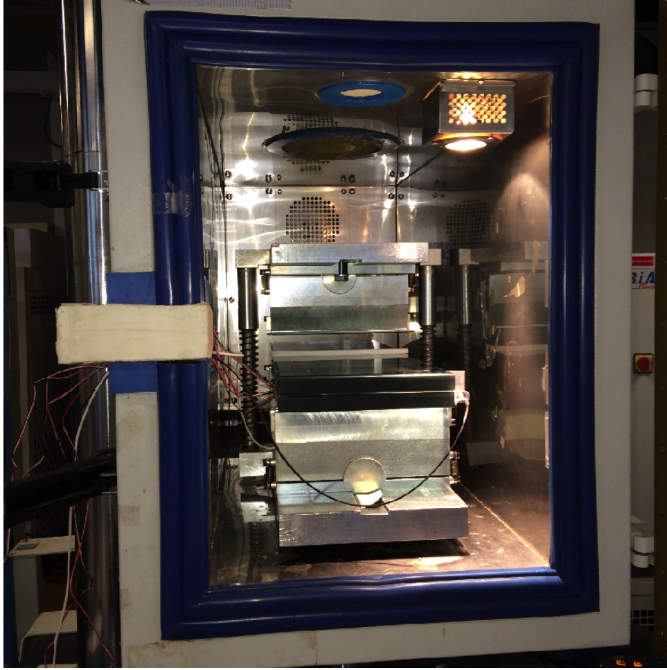
FIGURE 5.4 – Banc d’essai et plaque de verre feuilleté placés dans l’enceinte thermique.
