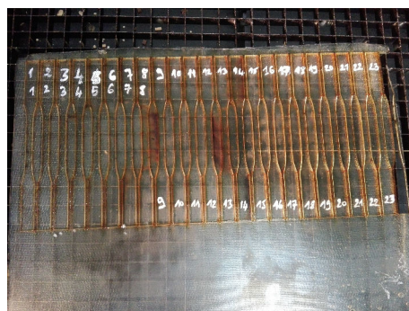
FIGURE 2.10 – plan de découpage des plaques 100 % matrice époxy
