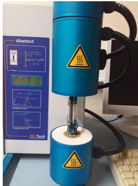
FIGURE 2.4 – machine kinetech utilisée pour l'identification de la T_g
