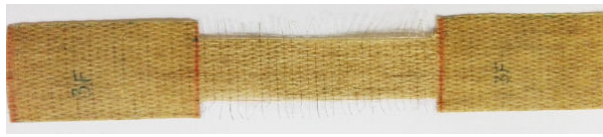
FIGURE 2.7 – éprouvette en renfort tissu
