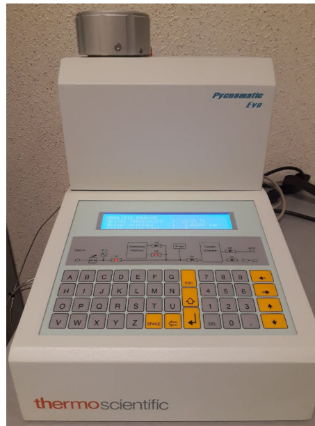
FIGURE 2.12 – présentation du pycnomètre utilisé pour la mesure de densité
