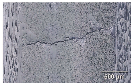
(c) Coalescence des fissures en une fissure transverse complète à partir de \epsilon = 1.6\%
