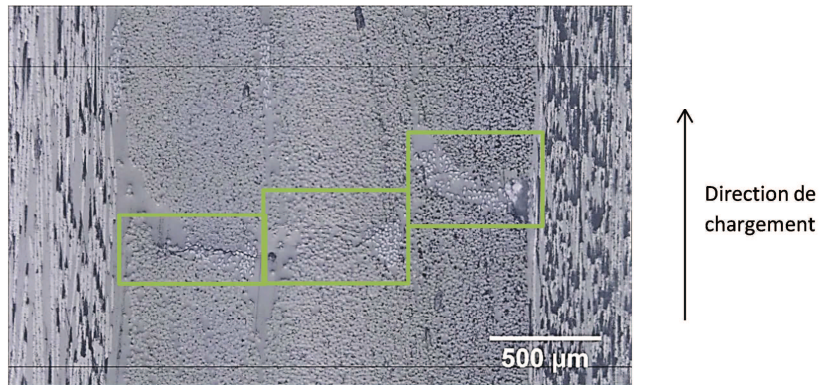
(a) Initiation de l'endommagement à partir de \epsilon=0.6\% , au niveau des fils de liage dans les espaces inter-torons, encadrés en vert
