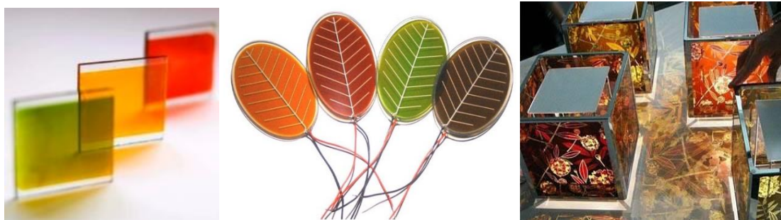
Figure I.3 : Images de cellules solaires à colorant avec divers couleurs et design
