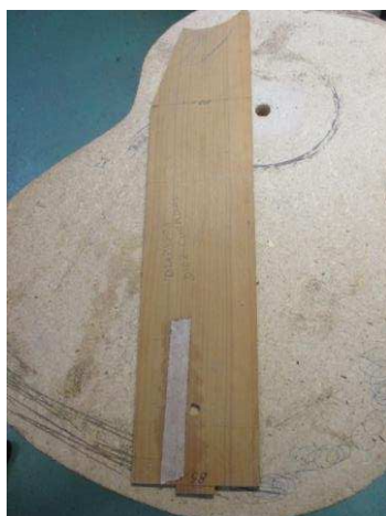
Modèle du manche de la guitare à dix cordes. Il est écrit sur ce prototype : « Diapason – Diez Cordas ». Maison Ramírez, Madrid.
