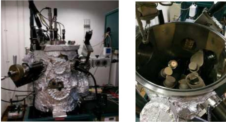
Figure 2.6: Gauche: Photo du bâti utilisé pour la réalisation des dépôts. Droite: Photo de l'intérieur du réacteur de dépôt montrant les six cibles visibles.
