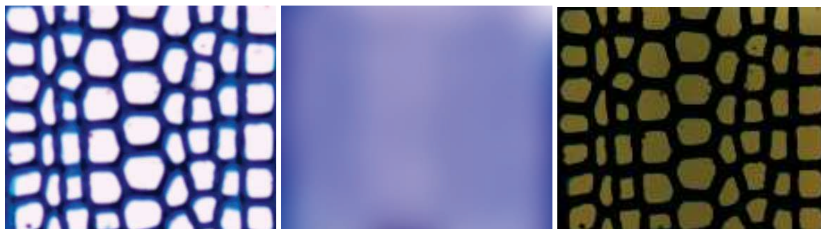
Figure 15. Rehaussement du contraste de l'image par la méthode de Différence de Gaussienne (DoG). A gauche l'image résultante d'un faible DoG ( \sigma = 3 pixels). Au centre, l'image résultante d'un fort DoG ( \sigma = (\text{largeur image})/10 ). A droite, la soustraction des images A et B qui augmente le contraste lumen/paroi.
