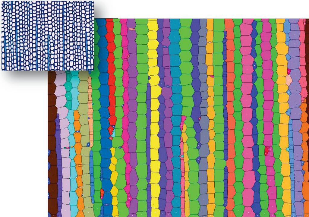
Figure 39. Résultat de la modélisation des files cellulaires. Chaque file est aléatoirement colorée. 88% des files sont reconnues par la méthode avec un temps d'exécution de 10,4 sec.
