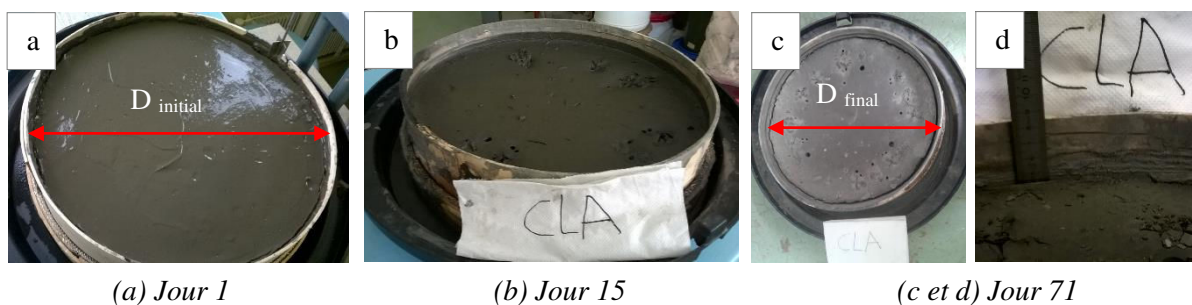
Figure A.2.6-3. Tassement et retrait des sédiments « AL-CLA ».
