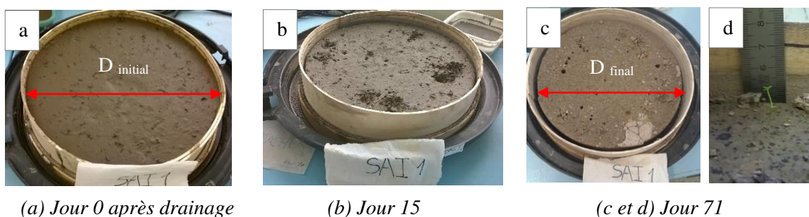
Figure A.2.6-6. Tassement et retrait des sédiments « BR-SAI ».
