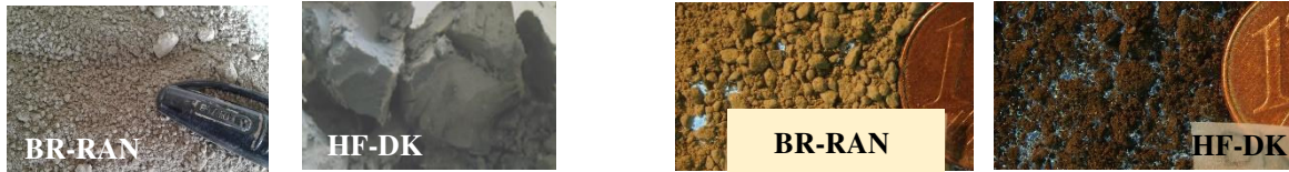
(a) Sédiments marins avant tamisage. (b) Sédiments marins après tamisage à 2mm.
