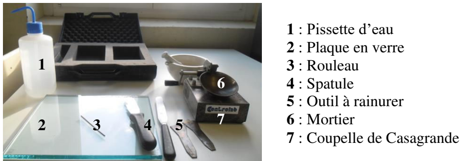
Figure 3-4. Matériel nécessaire pour la détermination des limites d'Atterberg.
