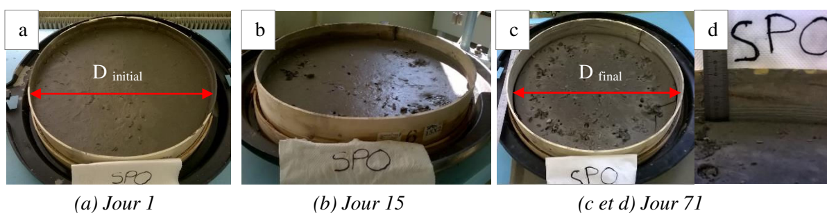
Figure A.2.6-2. Tassement et retrait des sédiments « AL-SPO ».
