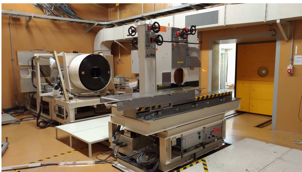
Figure 50 : Photo de la sortie du faisceau et du porteur d'échantillons de l'HIMAC
