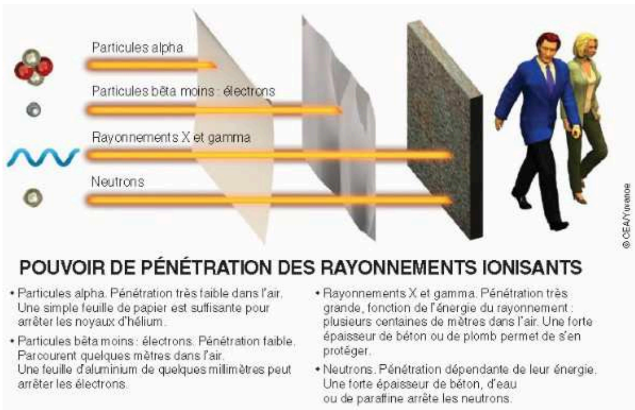
Figure 12 : Pouvoir de pénétration des rayonnements ionisants dans la matière (20)
