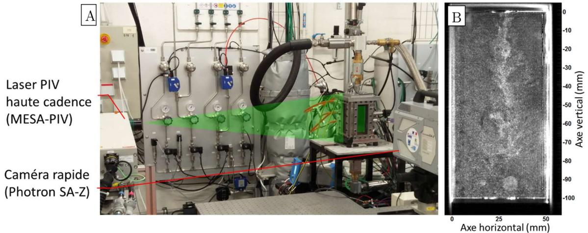
Fig. 2-19. A. Photo du montage de PIV (la nappe laser est superposée). B. Tomographie par diffusion de Mie des gouttelettes d'huile de pépin de raisin dans l'écoulement (image brute d'acquisition de PIV).
