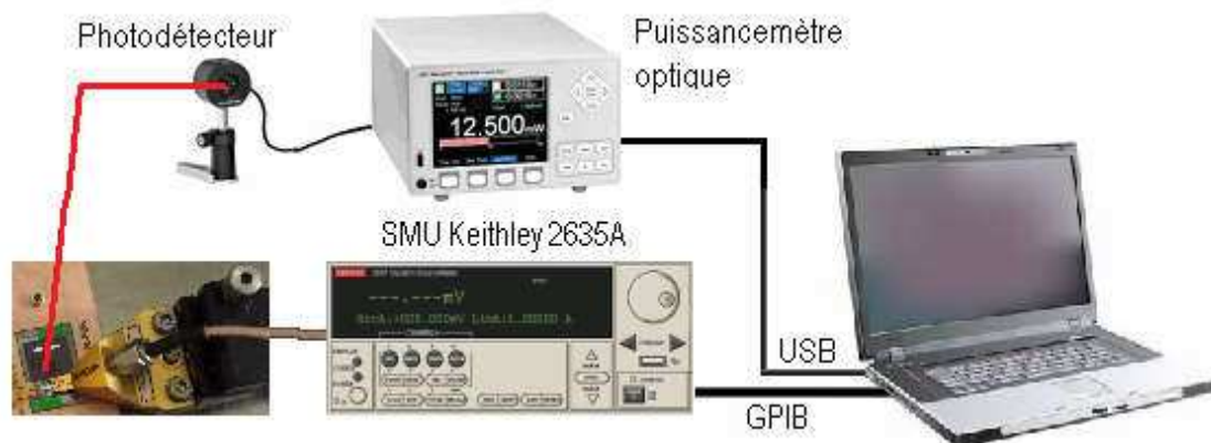
Figure 3.15 : Photo du banc de caractérisation JVL à bas niveau sourcemètre Keithley 2635A / photodiode Newport 918D / puissance mètre optique Newport 2935C
