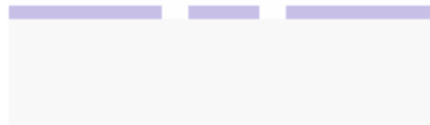
Figure 3.7 : Gravure – transfert du motif du masque de résine dans la couche d'ITO
