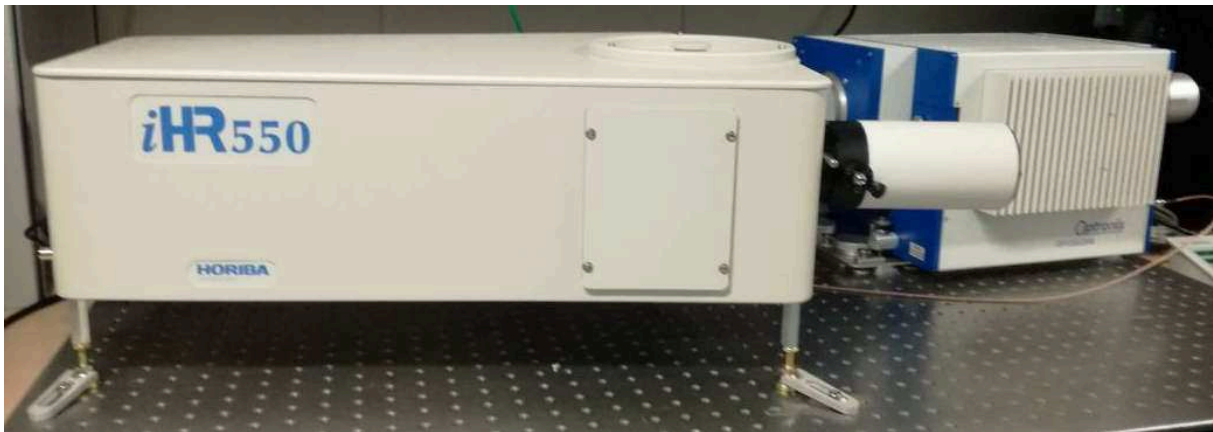
Figure 3.19 : Spectromètre à réseau HORIBA iHR 550 de Jobin-Yvon
