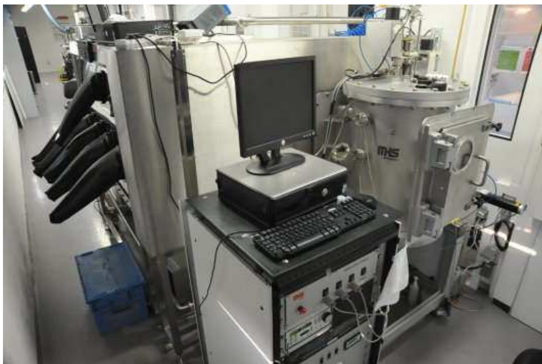
Figure 3.13 : Bâtiment d'évaporation MHS équipé (à droite) et commande électronique (à gauche), couplé à une boîte à gants (derrière)
