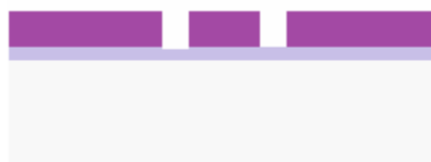
Figure 3.6 : Développement du masque de résine : La solution de développement dissout les zones insolées de la résine (voir Figure 3.4c) et laisse apparaître un masque de résine
