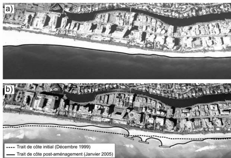
Fig. 2.2 Images satellites de la plage de Miami Beach (Floride, États-unis) montrant les conséquences néfastes à moyen terme de l'installation de trois brises lames. a) Prise de vue initiale réalisée en Décembre 1999 et b) 5 ans plus tard. Les trois brises lames ont été installées dans les années 2000. Images obtenues via Google Image.
