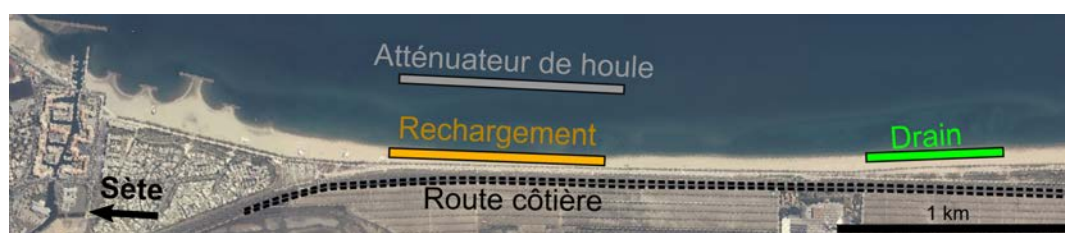
Fig. 4.4 Stratégie d'aménagement au Lido de Sète avec indiqués les positions des différents systèmes (fond de carte orthophoto ©IGN 2011).
