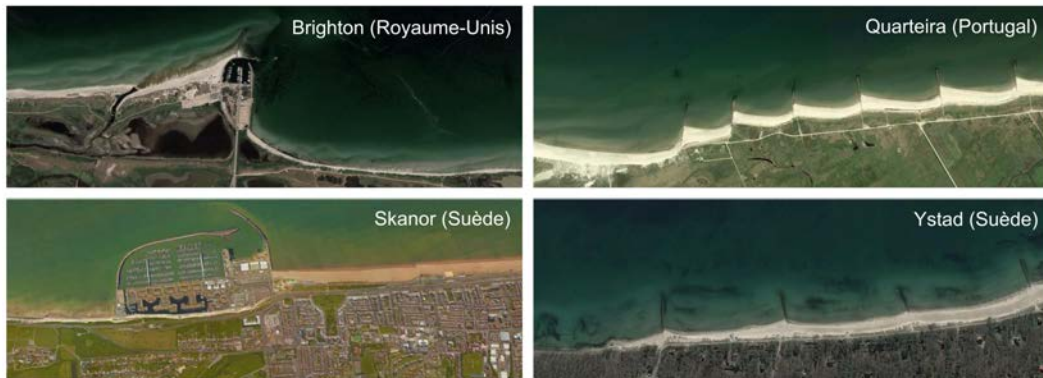
Fig. 2.13 Images satellites montrant les l'impact à moyen terme de l'installation d'ouvrages transversaux (jetés ou épis) sur différents littoraux sableux. Images obtenues via Google Image.
