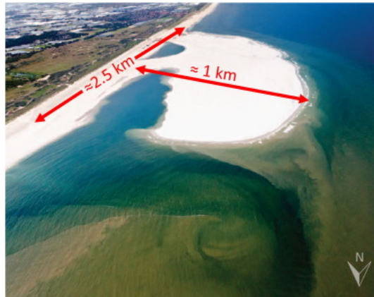
Fig. 2.15 Photographie aérienne montrant les dimensions du SandMotor (Pays-Bas) en septembre 2011. Illustration extraite de (Huisman et al. , 2016).
