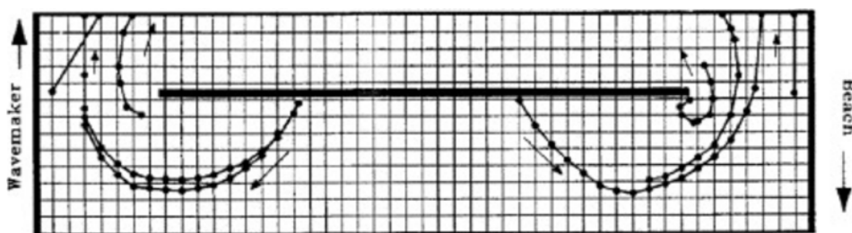
Fig. 2.17 Circulation bidimensionnelle obtenue par modélisation physique en canal à houle (Dean et al., 1994).
