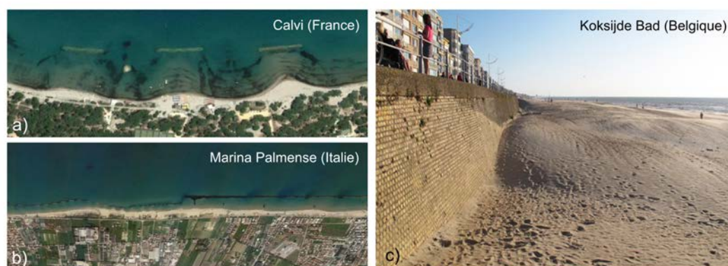
Fig. 2.14 (a-b) Images satellites montrant l'impact à moyen terme de l'installation d'ouvrages longitudinaux ou brise-lames à Calvi (Corse, France) et Marina Palmensa (Fermo, Italie). Images obtenues via Google Image. (c) Photographie de l'érosion au pied d'un mur de défense (Pranzini et al., 2015).
