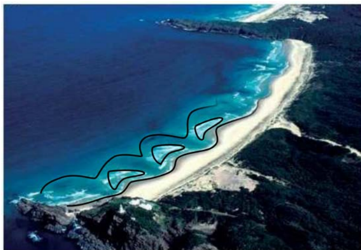
Fig. 2.11 Photographie montrant les morphologies couplées entre les zones subtidales et intertidales. Chaque croissant est associé à une barre intertidale parallèle à la côte et déconnectée du haut de plage. Les oscillations du trait de côte sont couplées à la géométrie des barres. Illustration adaptée de Price (2013), communiquée par A. D. Short.
