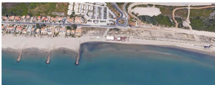
Fig. 1.1 Photo aérienne de la plage de Carnon (Occitanie, France) montrant le blocage du transport sédimentaire en amont-transit des épis (à gauche sur la photo) et le déficit en aval-transit (à droite). Image obtenue via Google Image.
