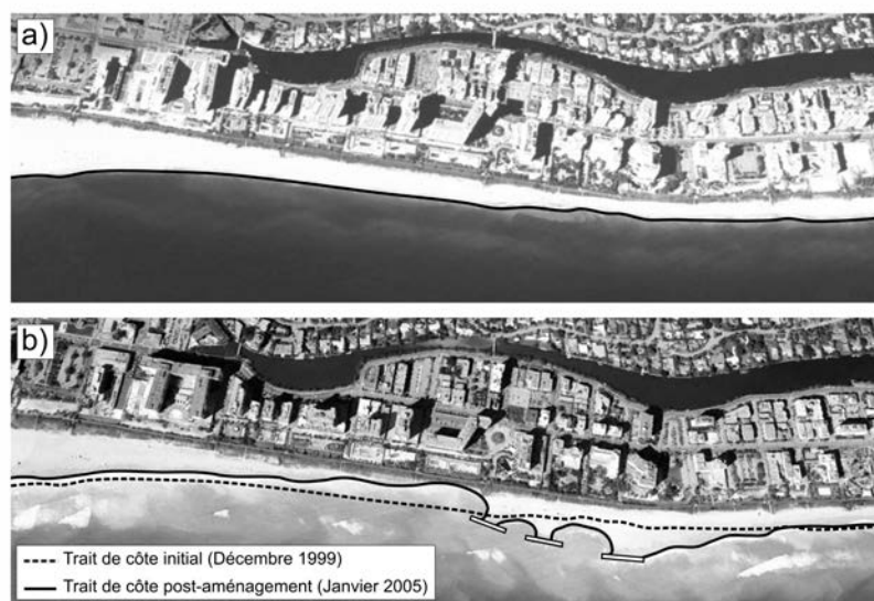
Fig. 2.2 Images satellites de la plage de Miami Beach (Floride, États-unis) montrant les conséquences néfastes à moyen terme de l'installation de trois brises lames. a) Prise de vue initiale réalisée en Décembre 1999 et b) 5 ans plus tard. Les trois brises lames ont été installées dans les années 2000. Images obtenues via Google Image.
