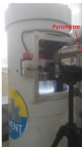
Figure II.4 : Pyromètre utilisé pour mesurer la température durant la déformation HPT, à Saint Petersburg.
