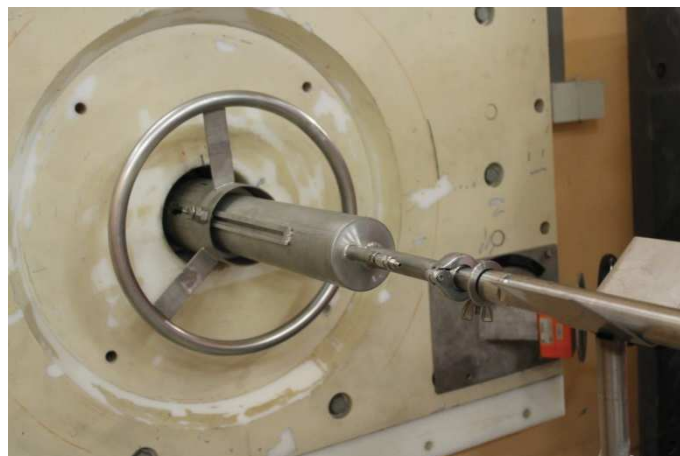
Figure 4.8 : Photographie prise selon le point de vue 5 de l'emplacement 4 du canon de transfert accosté à la porte fermée du caisson et raccordé au système de positionnement.
