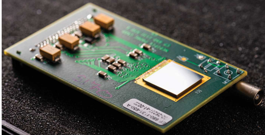
Figure 2.2 : Photographie d'une puce Timepix placée sur une carte électronique de lecture et de support.
