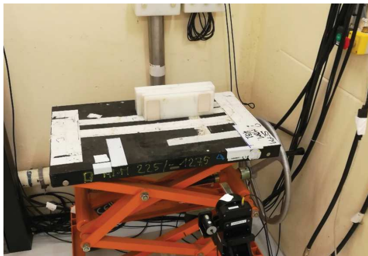
Figure 4.41 : Photographie de la configuration expérimentale avec l'écran neutronique en polyéthylène.
