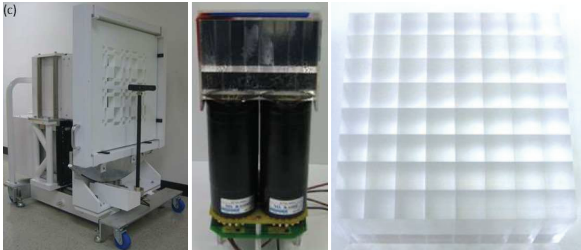
Figure 1.45 : À gauche : second prototype d'imageur gamma/neutron par encodage spatial à l'aide d'un masque codé du Oak Ridge National Laboratory ; au milieu : module de détection sensible à la position ; à droite : grille de 8 \times 8 pixels remplie du scintillateur organique liquide [62].
