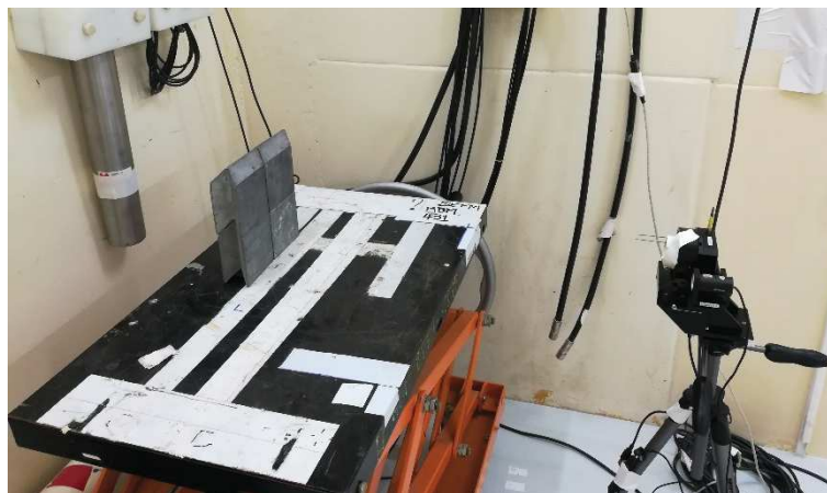
Figure 4.42 : Photographie de la configuration expérimentale de l'écran photonique en plomb.
