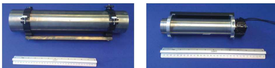
Figure 1.33 : À gauche : collimateur large en tungstène de 10 cm de diamètre extérieur, de 5 mm d'épaisseur et de 43 cm de longueur ; à droite : collimateur étroit en tungstène de 5,7 cm de diamètre extérieur, de 10 mm d'épaisseur et de 25 cm de longueur [51].
