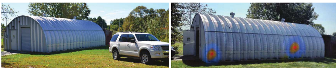
Figure 1.16 : À gauche : déploiement dans une voiture du prototype d'imager gamma/neutron par diffusion élastique de l'Université du New Hampshire ; à droite : image neutronique d'une source de ^{252}\text{Cf} et image gamma d'une source de ^{137}\text{Cs} placées à une distance de 10 m superposées à l'image visible (durée et débit d'émission neutronique non précisées) [29].
