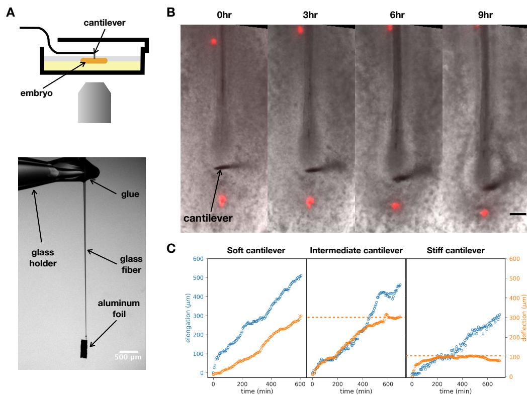
FIGURE D.13 – Mesure de la force d’élargissement *in vivo*. A : Montage expérimental. B : Déflexion du senseur de force au cours de l’élargissement. C : Mesure de l’élargissement et de la déflexion pour différentes raideurs de senseur de force.
