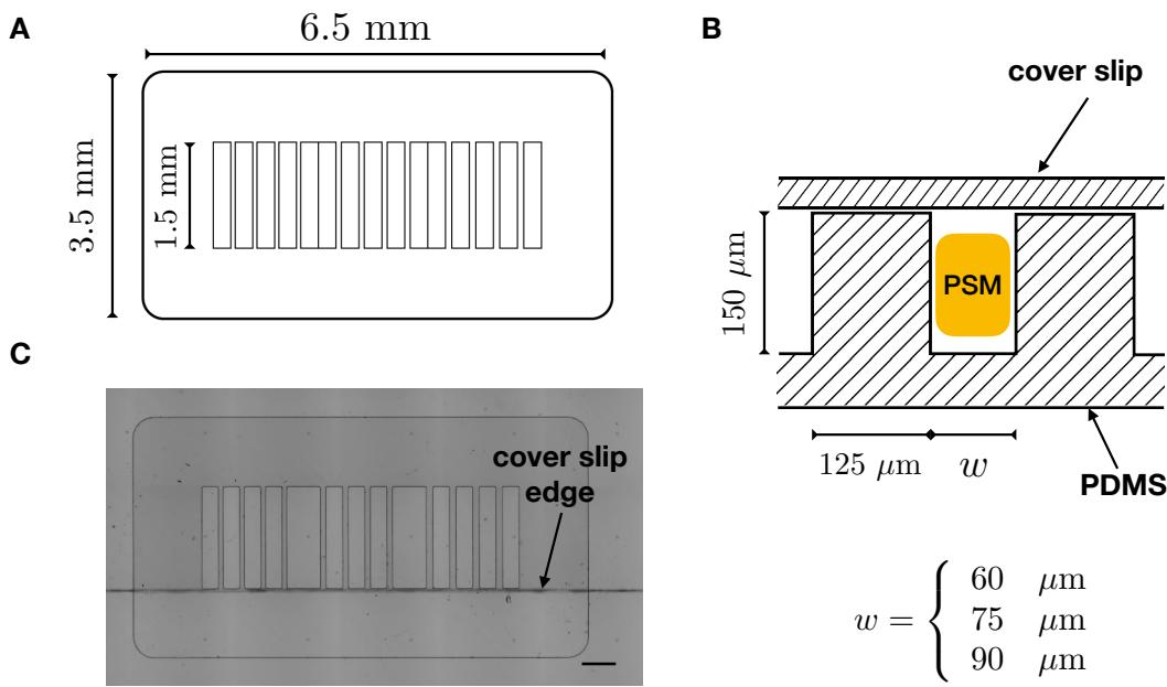
FIGURE D.14 – Fabrication de microcanaux. Schéma de la série de microcanaux vue du dessus (A) et vue de côté (B). C : Cliché de microscopie de la série de microcanaux. Échelle : 250 μm.
