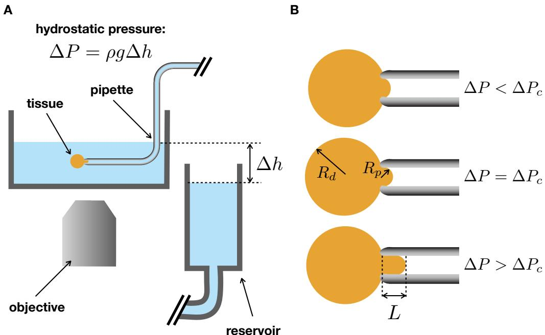
FIGURE D.9 – Principe d’aspiration par micropipette. A : Schéma d’un montage d’aspiration. B : Schéma d’une goutte visqueuse aspirée sous différents régimes de pression :  $\Delta P < \Delta P_c$  : la courbure dans la pipette augmente avec la pression,  $\Delta P = \Delta P_c$  : la courbure dans la pipette est maximale ( $2/R_p$ ),  $\Delta P > \Delta P_c$  : la courbure dans la pipette reste constante et la goutte flue dans la pipette.
