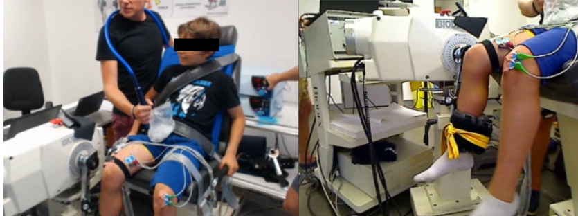
Figure 10 : Placement du sujet sur le dynamomètre pour l'évaluation des extenseurs du genou.
