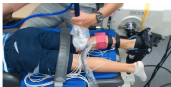
Figure 11 : Placement du sujet sur le dynamomètre pour l'évaluation des fléchisseurs plantaires.
