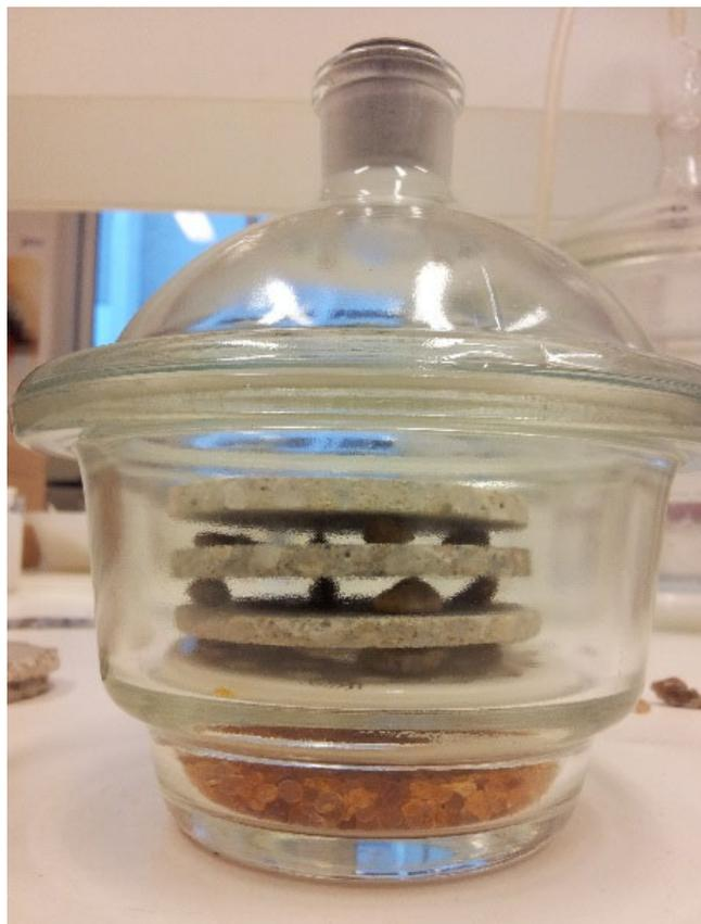
Figure 2.8 – Dispositif utilisé pour l'essai de sorption/désorption [MAI 13]
