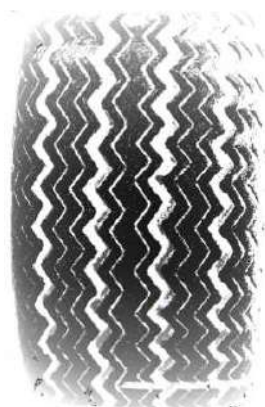
FIGURE 4.8 – Profil de pneu 5.2S10 numérisé par la méthode de projection de franges
