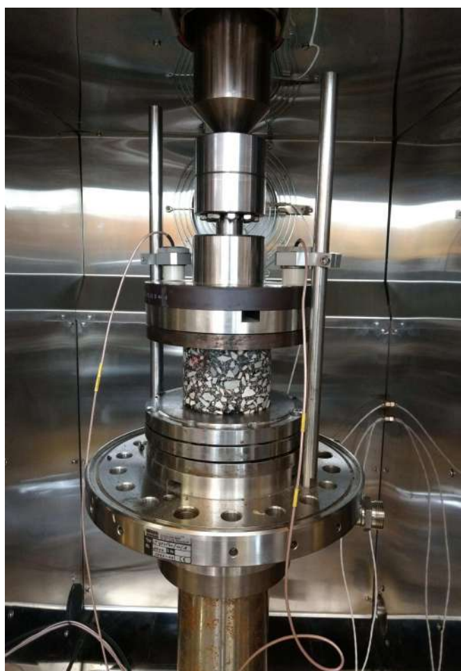
FIGURE 5.17 – Dispositif du montage de l'éprouvette instrumentée par deux capteurs de déplacement à courant de Foucault
