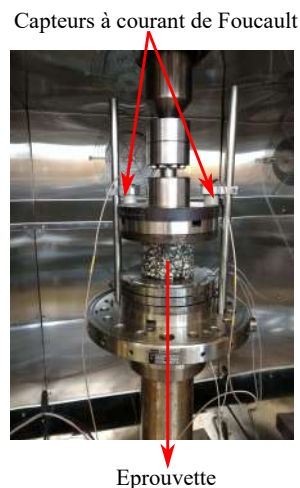
FIGURE C.2 – Photo du montage de l'éprouvette instrumenté par des capteurs à courant de Foucault
