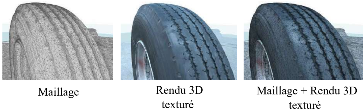
FIGURE 4.10 – Photogrammétrie : maillage et rendu après traitement de données
