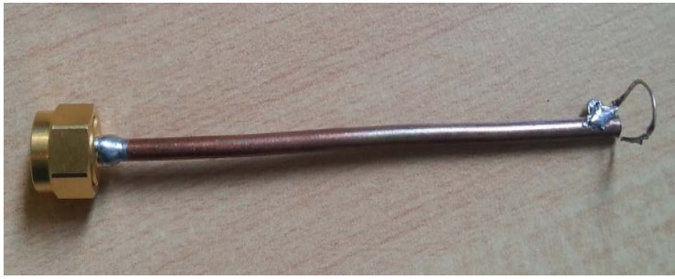
Fig 3.24: Sonde de champ classique de type magnétique utilisée en mesure champ-proche.
