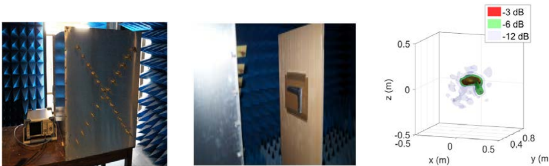
Fig 1.18: (gauche) Photographie de la cavité chaotique réverbérante connectée à un réseau d'antennes Vivaldi (milieu) Photographie de la configuration d'imagerie d'une cible métallique en forme d'arme à feu (droite) Résultat de l'image reconstruite de la cible (figure provenant de [52]).
