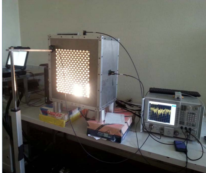
Fig 2.25: Dispositif expérimental pendant la mesure des fonctions de transfert. Un guide d'onde, relié à un port du VNA, est placé dans le champ proche de la cavité et sur les autres ports de la cavité les sorties de la cavité y sont reliées et mesurées.
