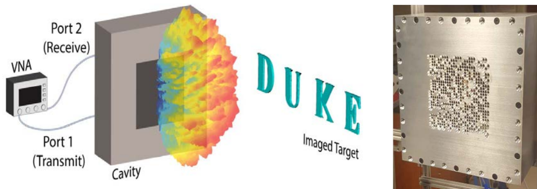
Fig 1.19: Système d'imagerie (gauche) représentation du dispositif d'imagerie (les lettres "D", "U", "K" et "E" sont imagées individuellement (droite) Cavité construite pour l'expérience (figure provenant de [55]).
