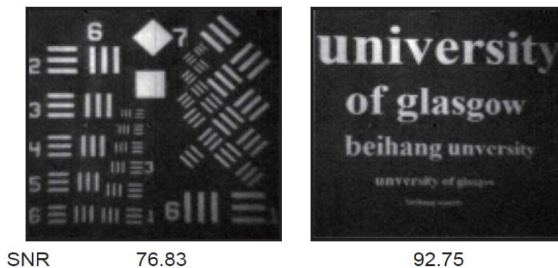
Fig 1.7: Images obtenues illustrant les distributions d'intensité (gauche) à travers deux lignes verticales de la carte de test de résolution de l'US Air Force (USAF), contenant différentes fréquences spatiales; (droite) Imagerie des lettres: University of Glasgow et Beihang University (figure provenant de [27]).
