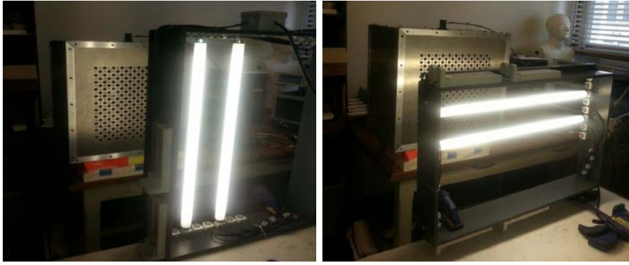
Fig 3.18: Photographie des scènes à imager. Deux lampes fluorescentes espacées de 11 cm. Le système passif est constitué de la cavité chaotique et d'un oscilloscope numérique.
