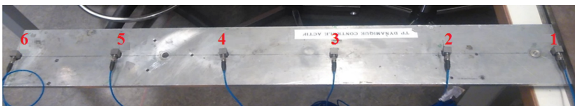
FIGURE 2.4. Emplacement des accéléromètres sur la poutre.
