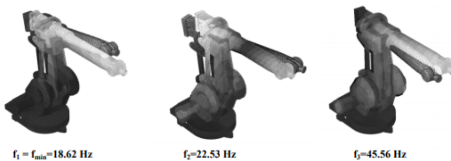
FIGURE 1.8. Fréquences propres et déformées modales associées d'un robot de type ABB IRB 1400 [Karagulle et al., 2012]
