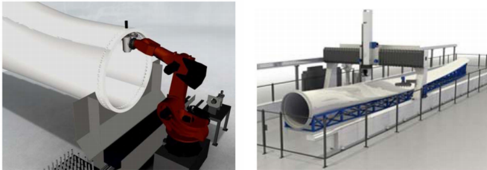
FIGURE 1.1. Robot remplaçant une machine d'usinage CNC (MAG IAS) [Karim, 2013].
