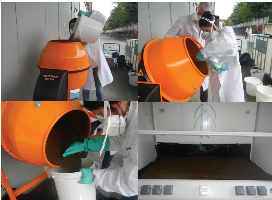
Figure 11. Protocole de contamination de la nourriture – 25 kg de granulés versés dans la bétonnière pour le mélange avec la solution de contamination, suivis de la phase de séchage sous hotte.
