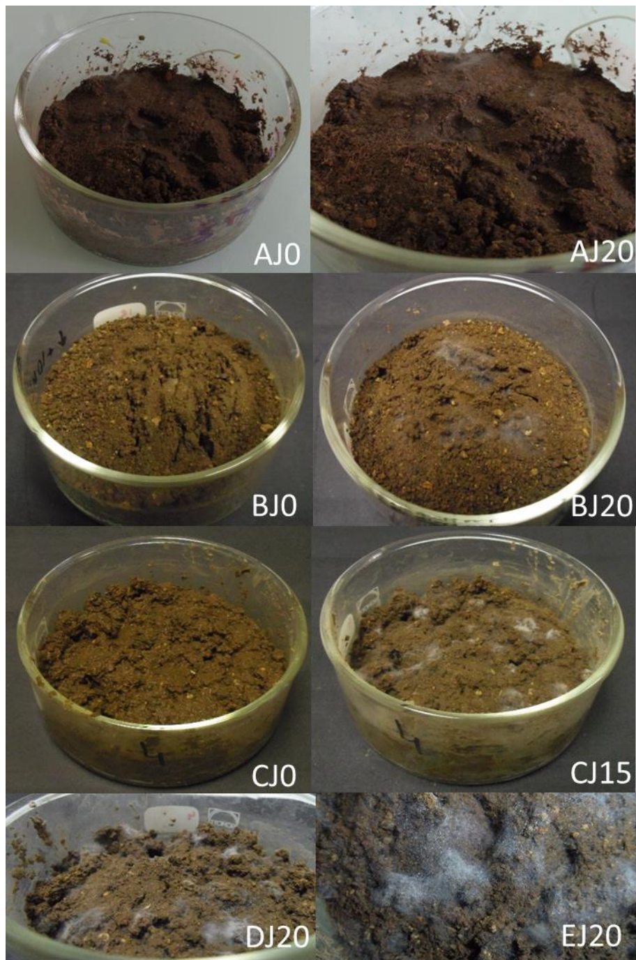
Figure 32 : photographies des microcosmes au début de l'essai (J0) et à la fin de l'expérience (J20) montrant le développement fongique pour le microcosme témoin (AJ0 et AJ20), le microcosme biostimulé (BJ0 et BJ20) et le microcosme bioaugmenté avec A. cylindrospora (CJ0 et CJ15). Des détails de ce dernier microcosme en fin d'expérience sont présentés (DJ20 et EJ20).
