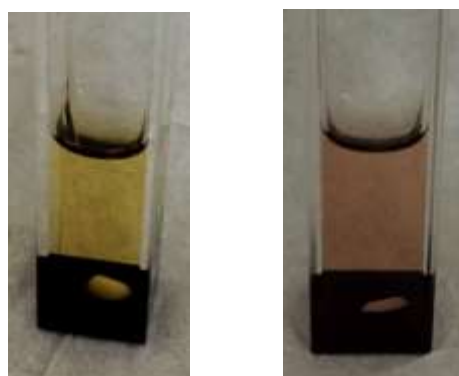
Figure III-44 : Changement de couleur de la solution de trans (NO,OH)-[RuFT(Cl)(OH)(NO)]PF 6 après irradiation dans le LB
