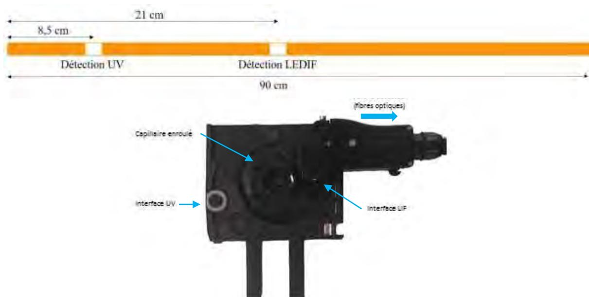
Figure 1-2 : Schéma du capillaire avec la double fenêtre UV et LIF ci-dessus et schéma de la cassette modifiée par Picometrics ci-dessous.
