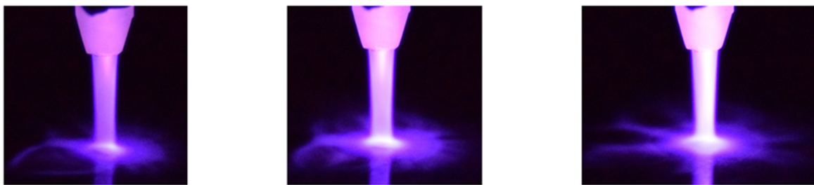
Figure 3-14. Photographies du jet plasma en présence de la cible diélectrique à 5 mm de la sortie de la source plasma (hélium à 2 L.min -1 , tension impulsionnelle, 2 kV, 20 kHz).
