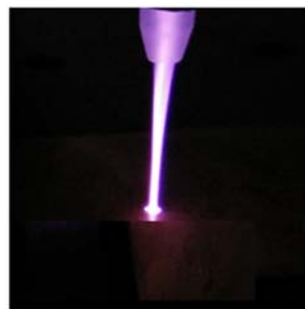
Figure 5-11. Photographie du jet plasma d'hélium interagissant avec une cible conductrice.
