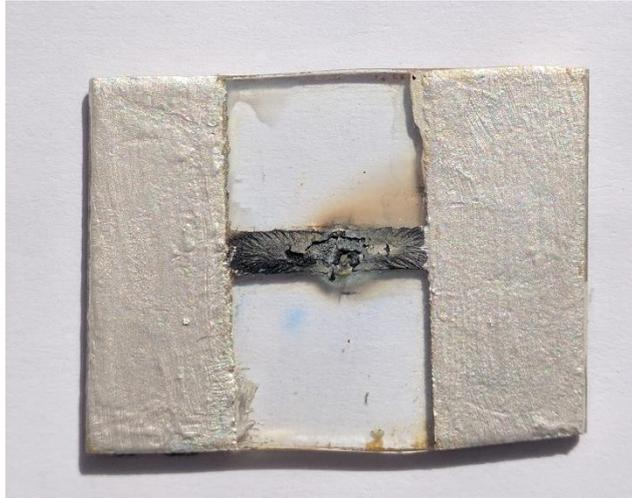
Figure 80 : Echantillon composite conducteur poly(époxy)/AgNWs à 2,3% volumique après détermination de la valeur limite de densité de courant
