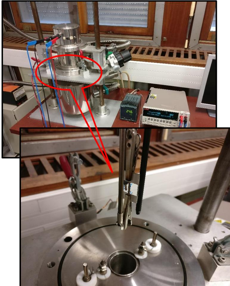
Figure 37 : Dispositif de mesure  $I=f(U)$
