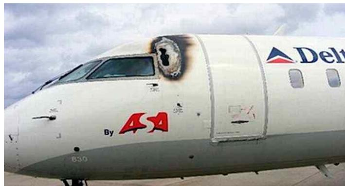
Figure 7 : Perforation de la peau due à un impact foudre Bombardier CRJ-200
