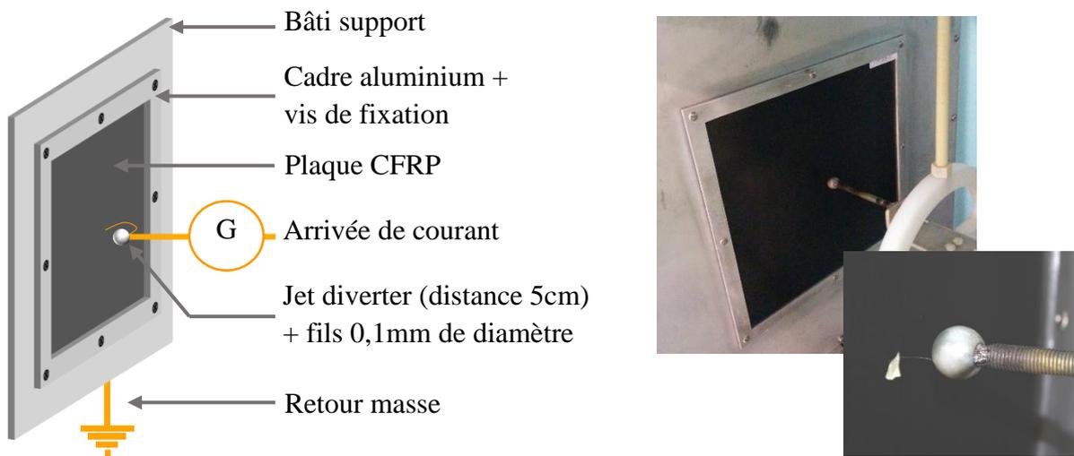
Figure 40 : Descriptif du banc d'essai d'impact foudre sur un CFRP
