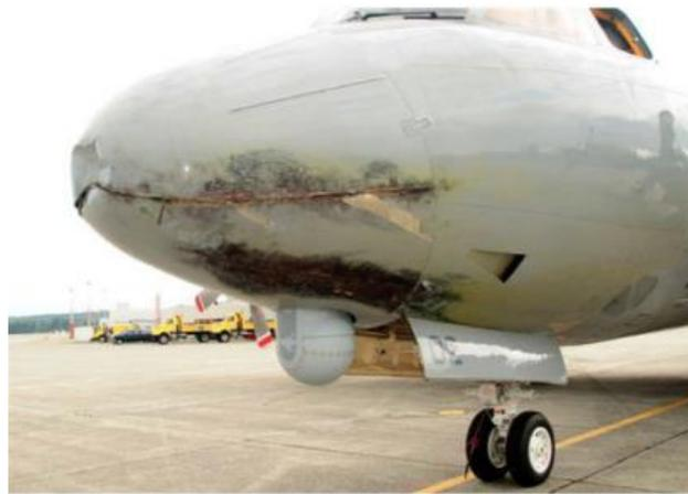
Figure 6 : Traces de brûlures d'accroche d'un impact foudre sur le radôme d'un avion
