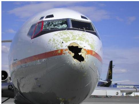
Figure 12 : Détérioration du radôme et du parebrise d'un avion suite à un impact foudre
