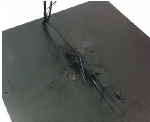
Figure 13 : CFRP délaminé suite à un impact foudre
