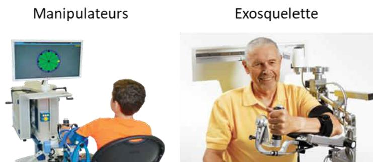
*Figure 23. Photos des deux grands types de dispositifs existants. A gauche : robot type manipulateur (InMotion 2.0 Interactive Motion Technologies, Watertown, MA, USA). A droite : robot type exosquelette (Armeo®, Hocoma, Switzerland).*
