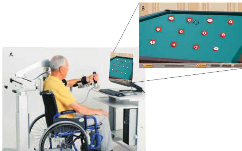
**Figure 110.** Illustration d'une session d'évaluation robotisée. A. Vue d'un patient installé sur l'Armeo@Spring (Hocoma, Suisse), en face de l'écran d'ordinateur sur lequel est installé le logiciel Armeocontrol 1.22. B. Illustration de la tâche « capture horizontale », présentée au patient. Les boules de billard rouges apparaissent successivement et représentent les cibles à attraper et le viseur, la main du patient.
