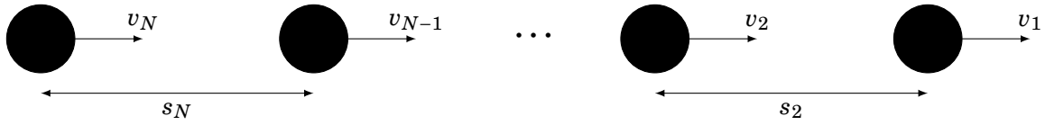
Fig. 3.6.: Discrétisation du réseau pour l'application à l'échelle Lagrangienne-Temporelle
