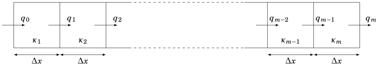
Fig. 3.4.: Discrétisation du réseau pour le CTM
