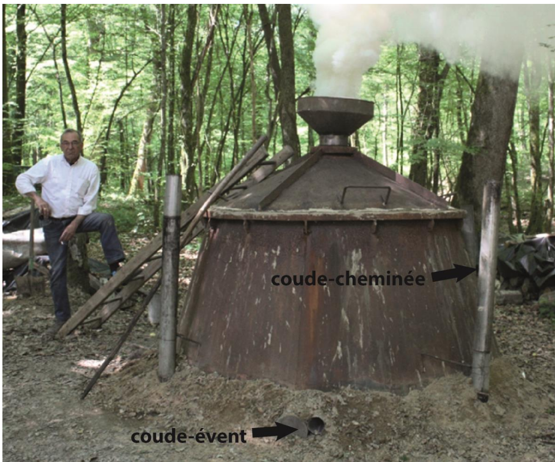
Figure a.5 : Mise en évidence des coude-évents et des coude-cheminées d'un four Magnein en fonctionnement (photo: A. Dupin)
