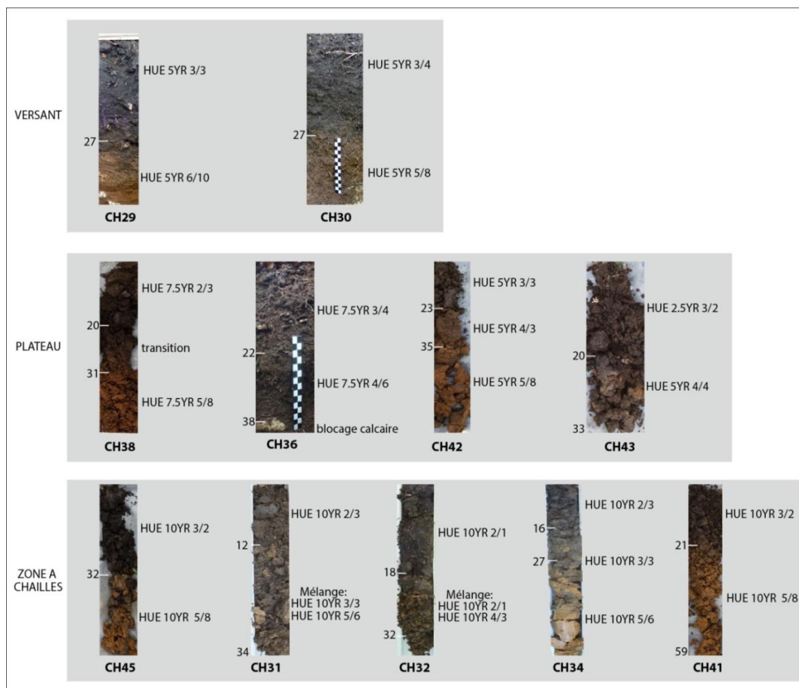
Figure 1.5 : Photographies des profils de sol des plateformes de charbonnage analysées de la forêt de Chailluz. Identification colorimétrique d'après le code Munsell.
