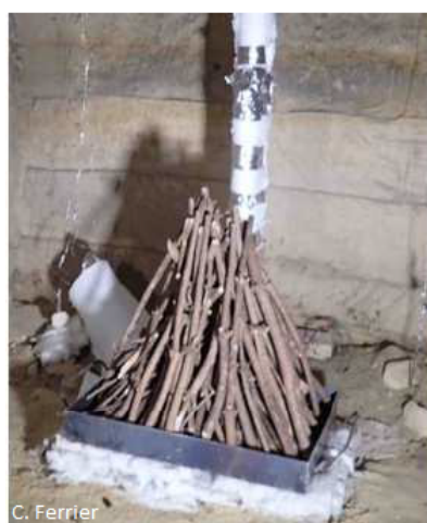
Figure 3.3 – Structure du foyer juste avant l'allumage composé de quatre fagots positionnés en tipi (environ 18 kg).
