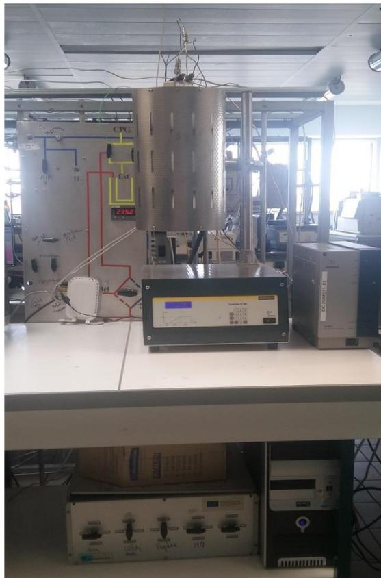
**Figure 24** : Montage expérimental de l'oxydation du propène utilisé dans le laboratoire
