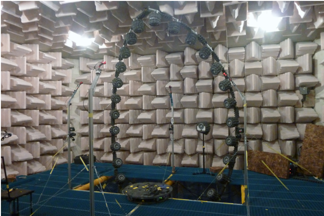
FIGURE 2.4 – Le système d’enceintes utilisées à Orange Labs Lannion pour mesurer les HRTF en salle anéchoïque. Pendant la mesure l’utilisateur, assis sur une table tournante, fait un tour complet sur lui-même, de façon à ce que les demi-cercles d’enceintes puissent émettre tout autour de lui.
