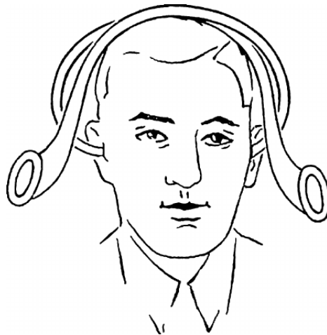
FIGURE 2.6 – Le pseudophone de Young, un dispositif permettant d'inverser l'audition de l'oreille droite avec celle de l'oreille gauche. Image tirée de [VURPILOT, 1963].
