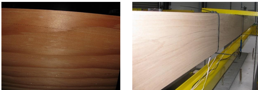
Figure 142 : Apparition de fissures sur les poutres de douglas (à gauche) et hêtre (à droite)
