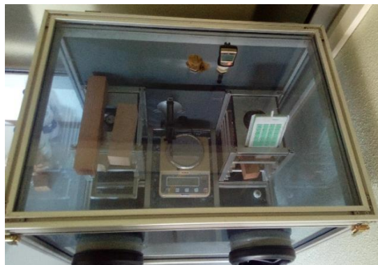
Figure 51 : Enceinte climatique de régulation d'humidité initiale
