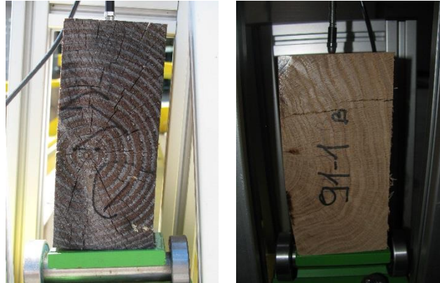
Figure 119 : Gauchissement aux appuis des poutres de douglas et de chêne en classe de service 2
