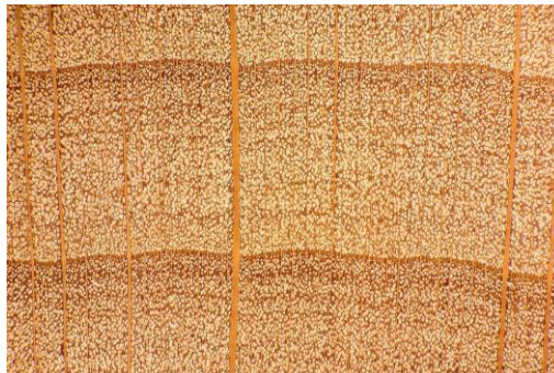
Figure 12 : Coupe transversale du hêtre (Trouy, 2016)
