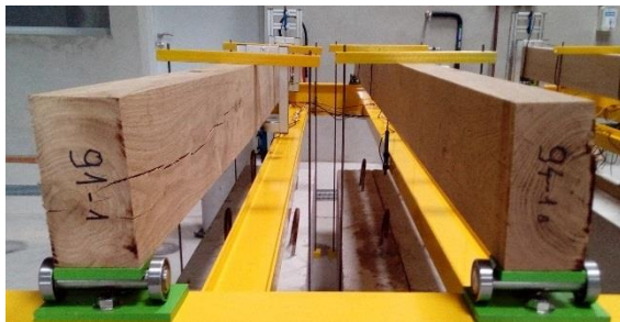
Figure 126 : Mise en évidence des fissures non traversantes sur la poutre de chêne C1 (91-1) le jour du chargement, en comparaison à la poutre C2 (94-1)
