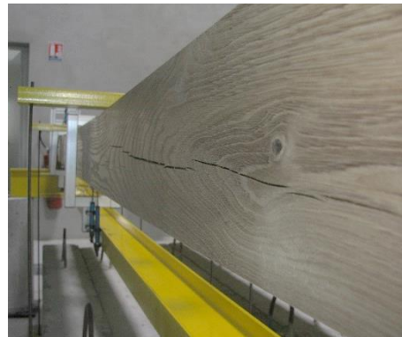
Figure 126 : Mise en évidence des fissures non traversantes sur la poutre de chêne C1 (91-1) le jour du chargement, en comparaison à la poutre C2 (94-1)
