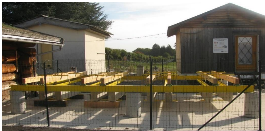
Figure 114 : Banc de flexion 4 points en extérieur
