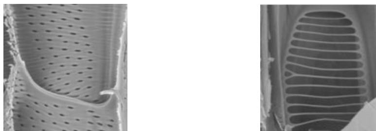
(a) : Perforation simple de l'érable vue au MEB
