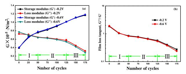
**Figure 4.** (a) Évolution des composantes réelles et imaginaires du module de cisaillement complexe et (b) évolution de la tangente du coefficient de perte du film entre -0,2V et -0,6V lors des cycles successifs.
