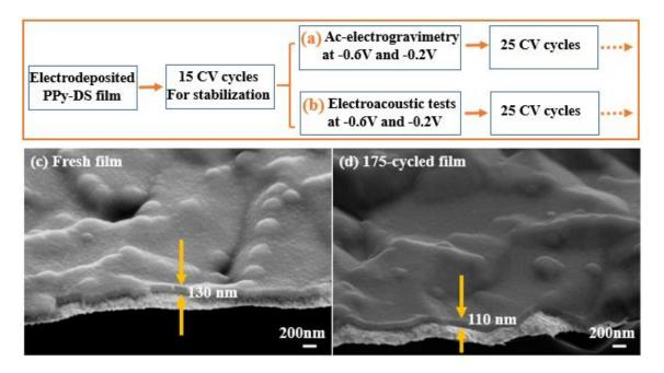
**Figure 2.** Illustration des proc édures de mesure pour (a) l'*ac*-dectrogravim étrie et (b) l'impédance dectroacoustique pendant le cyclage dectrochimique du film; (c) et (d) sont les observations morphologiques du film PPy-DS frais et apr ès 175 cycles par le FEG-SEM, respectivement.
