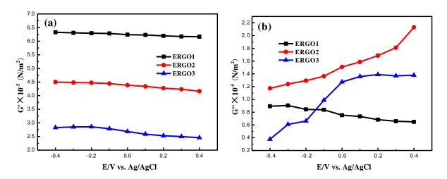
**Figure 7.** Évolution de (a) composantes rélles et (b) imaginaires du module de cisaillement complexe des dectrodes d'ERGO.
