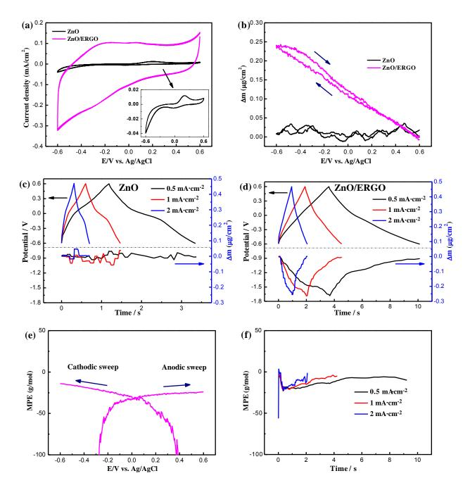
**Figure 13.** Courbes d'électrogravimétries à 100 mV/s (a, b) et courbes GCD à diff érentes densit és de courant (c, d) dans une solution de Na<sub>2</sub>SO<sub>4</sub> 0,25 M; (e) et (f) sont la masse correspondante par mole d'électrons de l'électrode charg é ZnO@ERGO calcul é à partir d'un cycle CV et GCD, respectivement.
