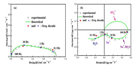
**Figure 10.**  $\frac{\Delta q}{\Delta E}(\omega)$  (a) et  $\frac{\Delta m}{\Delta E}(\omega)$  (b) fonctions de transfert à 0,3V vs Ag/AgCl dans une solution de Na<sub>2</sub>SO<sub>4</sub> 0,25 M.
