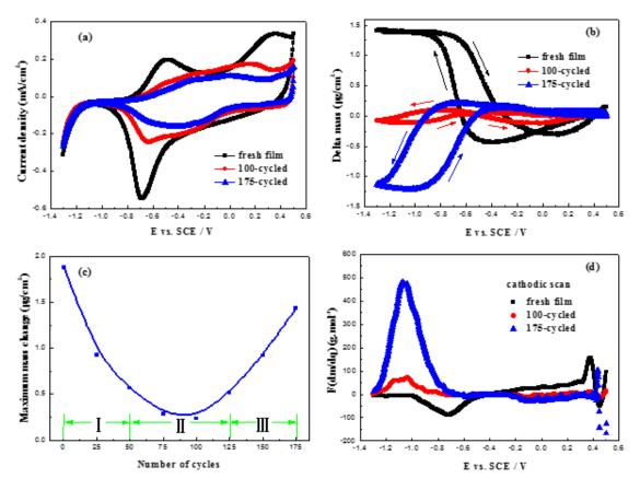
**Figure 3.** Voltamp érom étrie cyclique (a), variation de masse ( $\Delta m$ ) (b), variation de masse maximale (c) et fonction F(dm/dq) calcul ét à partir de la branche de réduction (d) du film PPy-DS dans une solution aqueuse de NaCl 0,25 M entre -1,3 V et 0,5 V vs ECS à une vitesse de balayage de 50 mV·s<sup>-1</sup>.
