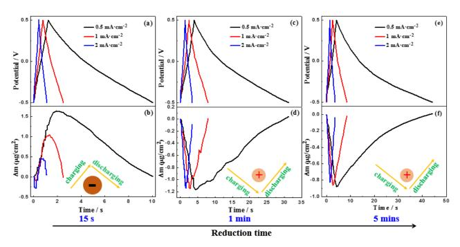
**Figure 6.** Charge-décharge galvanostatique de différents films ERGO-1 (a, b), -2 (c, d) et -3 (e, f) à une densit é de courant de 0,5, 1 et 2 mA·cm<sup>-2</sup>, respectivement.
