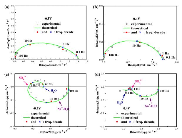
**Figure 14.**  $\frac{\Delta q}{\Delta E}(\omega)$  (a et b) et  $\frac{\Delta m}{\Delta E}(\omega)$  (c et d) fonctions de transfert à -0,5V et 0,4V vs Ag/AgCl dans une solution de Na<sub>2</sub>SO<sub>4</sub> 0,25 M.
