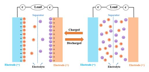
Figure 1. Illustration schématique d'un SC à l'éat chargéet déchargé
