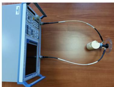
FIGURE 2.42 – Mesure de l'impédance de la MCC en MD.
