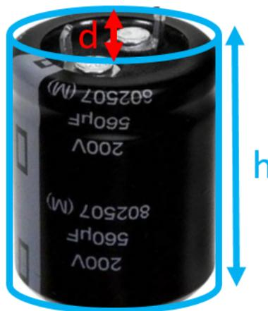
FIGURE 3.21 – Illustration du volume du *DC-link*.
