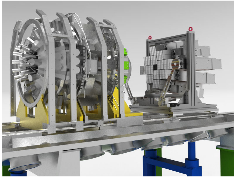
FIGURE 5.19 – Dessin technique du couplage entre les multi-détecteur INDRA (sur la gauche) et FAZIA (sur la droite) dans la chambre à réaction de INDRA , installé sur l’aire expérimentale D5 au GANIL .
