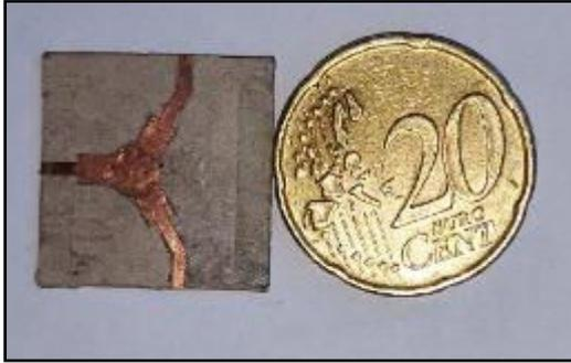
Figure III-20: Circulateur en technologie microruban classique fabriqué (dimensions : 19,9x19,5 mm<sup>2</sup>).
