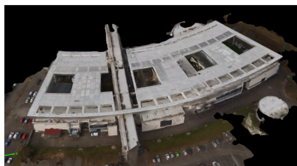
FIGURE 4.4 – Réalisation du modèle 3D, utilisé dans la partie localisation collaborative : Application au géo-référencement d'intérieur.
