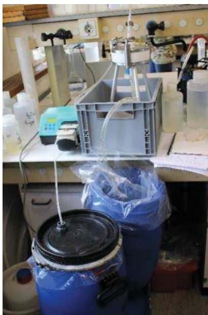
Figure 2-11 : Dispositif expérimental pour la filtration des solutions de sol
