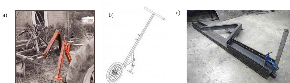
Figure 11. Illustrations a) d'un triangle d'attelage, b) d'un dessin de houe maraichère, c) d'une barre porte outils (d'après : https://www.latelierpaysan.org/ ).
