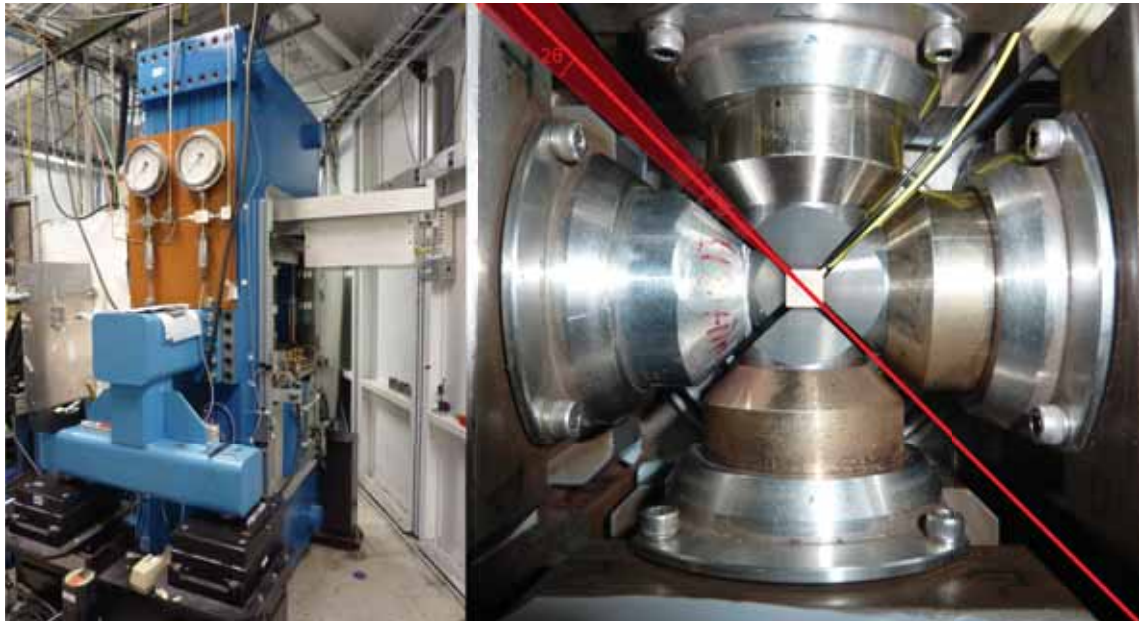
Figure 2.8 : À gauche : Presse SAM85. À droite : Vue de dessus des enclumes latérales et de l'assemblage avant le début de l'expérience. L'enclume de gauche est en diamants frittés alors que les 5 autres sont en carbure de tungstène. Le thermocouple s'insère dans l'angle en haut à droite de l'assemblage (fils à gaine noire et jaune). Le trajet des rayons X et le cône de diffraction sont représentés en rouge.
