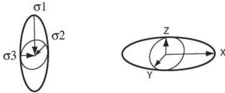
Figure 1.5 : Ellipsoïdes des contraintes (à gauche) et des déformations (à droite) selon un formalisme de géologue ( \sigma_1 = contrainte maximale, \sigma_3 = contrainte minimale). Les déformations sont à l'opposé des contraintes : plus la contrainte selon un axe est faible, plus celui-ci se déforme.
