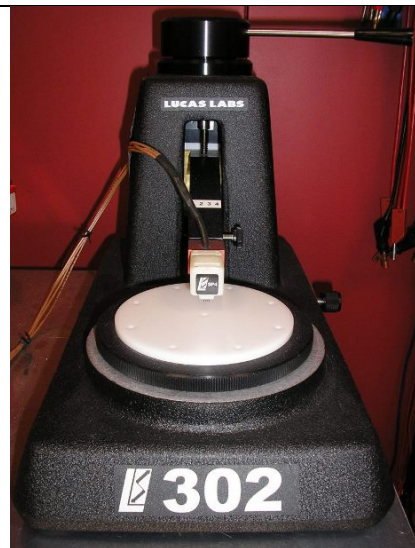
Figure 7-5 : Banc de mesures 4-pointes. Fournisseur MicroWorld.
