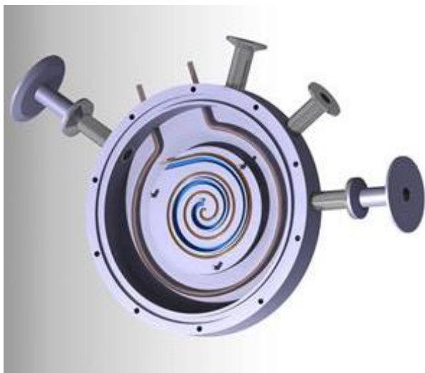
Figure 7-12 : Projet d'enceinte pour mesures Van der Pauw et effet Hall en température sous atmosphère contrôlée.
