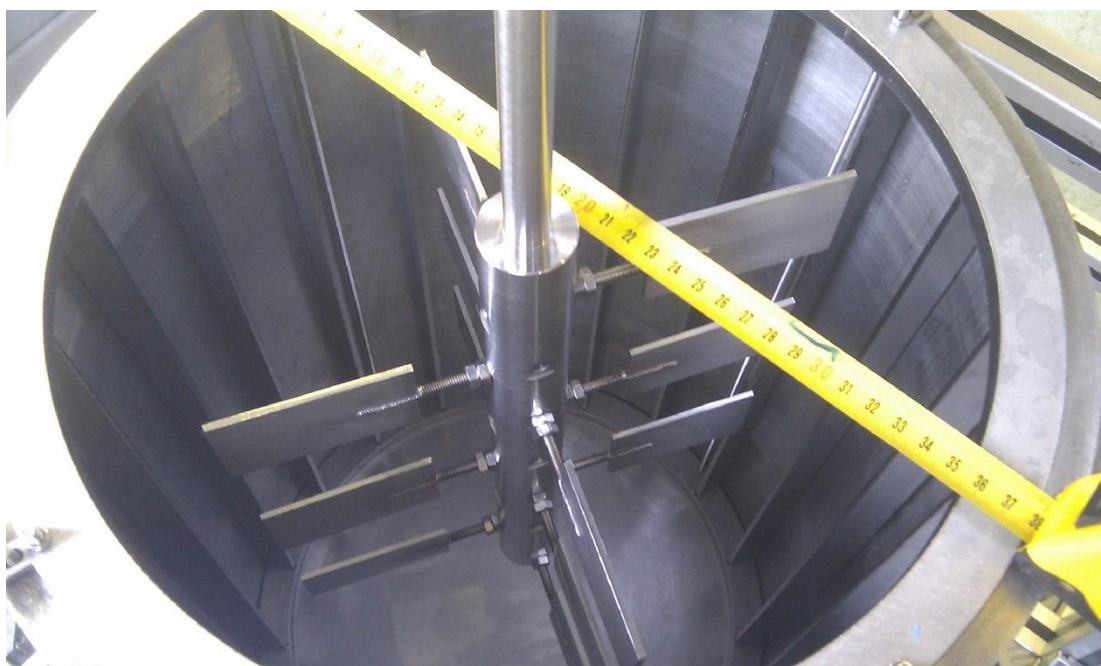
Figure II.5 : Le grand récipient avec la lame à ailettes (90°) et le système d'anti glissement sur la paroi.
