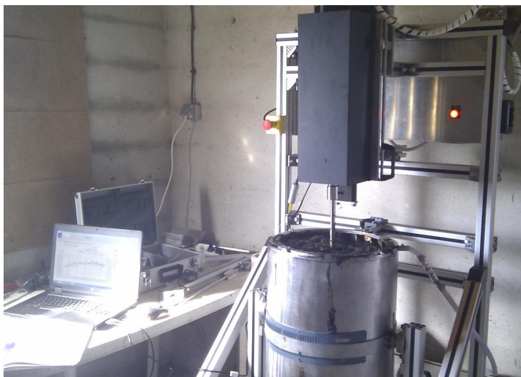
Figure II.18 : RGDS lors des mesures rhéométriques à Napagèse.
