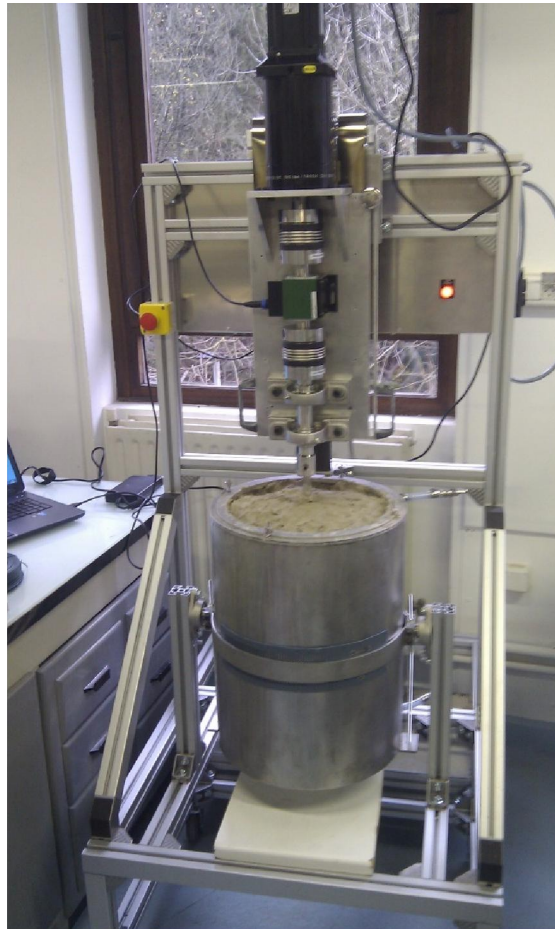
Figure II.2 : Photographie du RGDS lors de l'étalonnage de la grande pale de scissométrie en utilisant une pâte d'argile.
