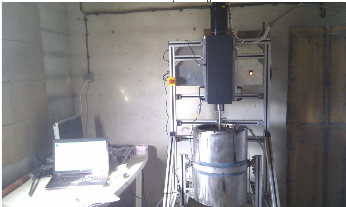
Figure II.3 : Photographie du RGDS lors de mesure de viscosité d'un digestat sur le site industriel de Napagèse
