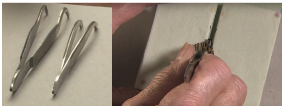
Figure 1.34. Deux pinces à piquer et leur utilisation © G. Muller, 2013.
